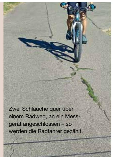
Zwei Schläuche quer über einem Radweg, an ein Messgerät angeschlossen – so werden die Radfahrer gezählt.
